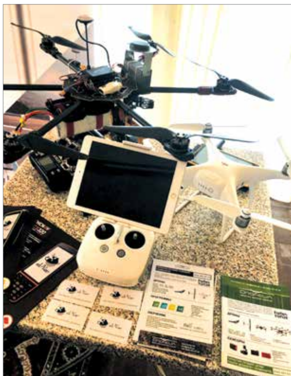
Рис. 2. Обладнання, що використовується для фотограмметрії – БПЛА Phantom 4 Advanced+
